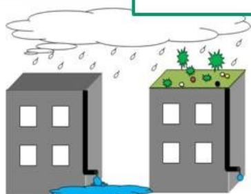
1. Tilbageholder regnvand 50-60 % og forsinker afløbet ved kraftige regnskyl.
