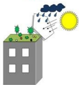
5. Vegetationen forlænger tagets levetid og beskytter mod UV-strålingen.
